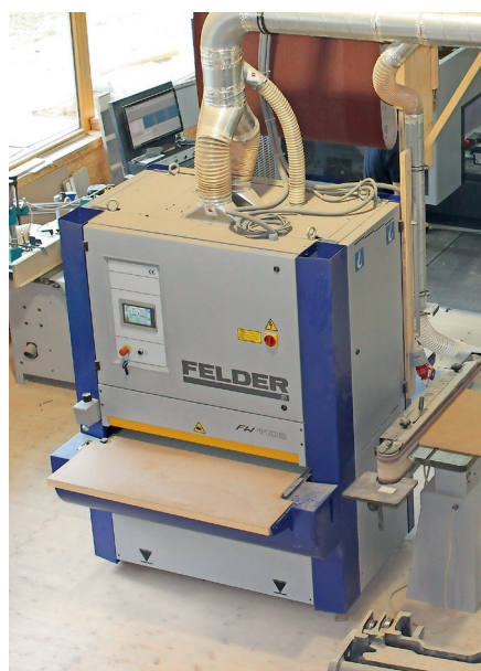
Vor- und Feinschliff erfolgen auf der Breitbandschleifmaschine FW 1102 in einem einzigen Arbeitsschritt.
