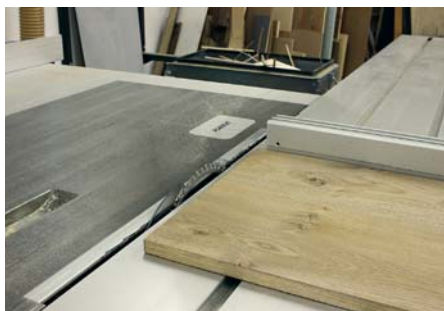
Die Formatkreissäge kappa 550 x-motion bietet eine extreme Schnitthöhe über 200 mm und einen 3-Achsvorritzer, der sich auch versenken lässt.
