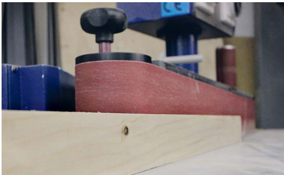
Kein Durchschleifen mehr: Die Kantenschleifmaschine FS900K hebt sich mit einer Furnierschleifeinrichtung ab. Man kann hier das Material sehr exakt anlegen.
