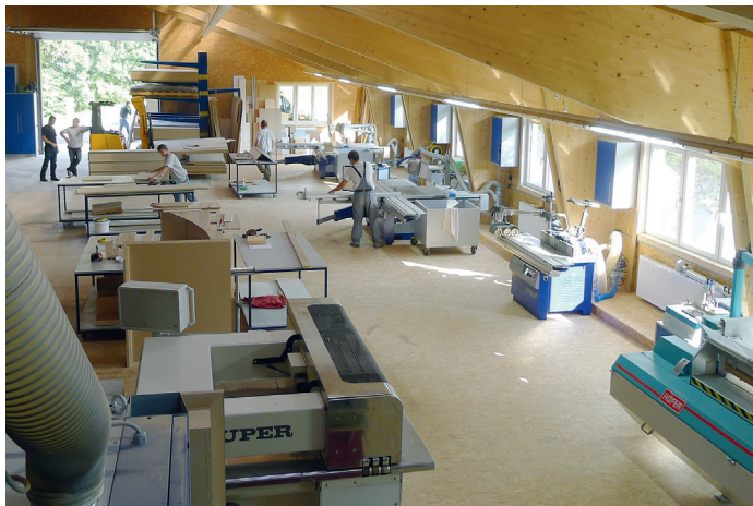
Der Maschinensaal mit den beiden Formatkreissägen
