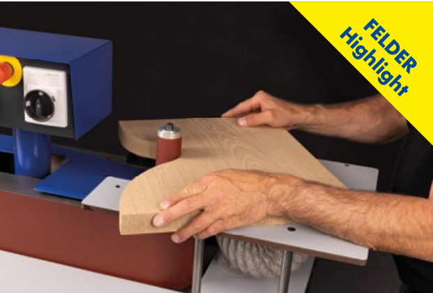
Extrabord och klämanordning Stödbordet (14.0.951) och spännorm (14.0.952) är till för böjda arbeten och bågar. Denna kan monteras på några sekunder och gör det möjligt att slipa snäva radier i kombination med spännorm (tillval).
