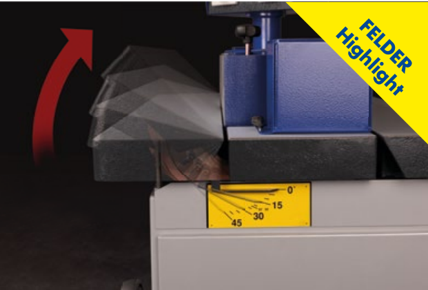
Slipbord Slipbordet är steglöst vinklingsbart mellan 90° och 45°.
