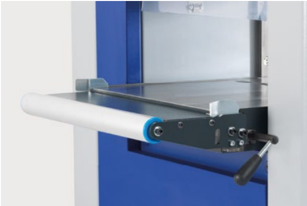
Опорный ролик Для обработки влажной древесины со значительным содержанием смолы используется опорный ролик для заготовки с автоматическим нанесением средства для улучшения скольжения.
