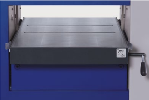
Регулируемый интегрированный ролик рабочего стола В качестве опции: регулируемые интегрированные ролики рабочего стола для обработки заготовок с высокой влажностью или значительным содержанием смолы.
