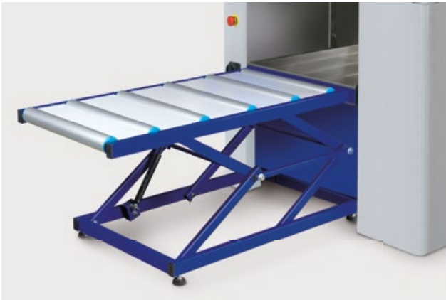
Ножничный подъёмный стол По запросу рейсмусовый стол может быть укомплектован ножничным подъёмным столом длиной до 1,150 мм.
