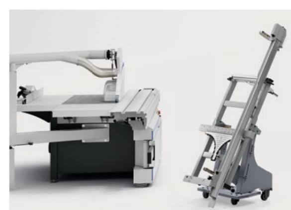
**Транспортная и монтажная тележка для расширительного стола**
