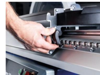
Фиксация в любом положении – система фиксаторов каретки
