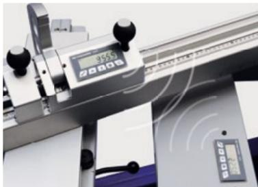
**"digi-compensation plus" – цифровой дисплей для системы компенсации угла/длины**
