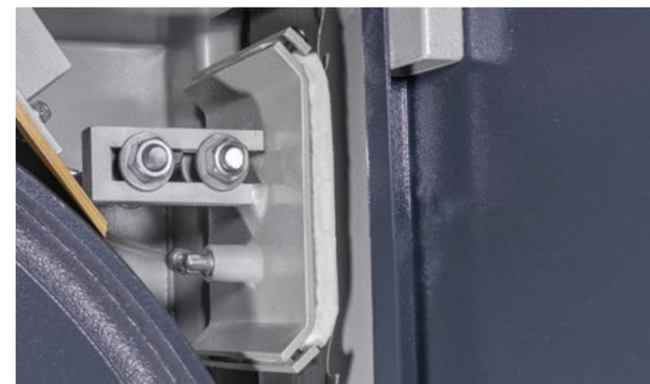
**Sistema de lubricación de la correa electroneumática**
