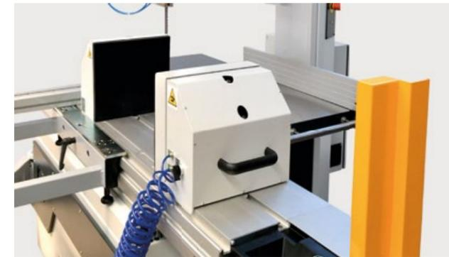
**Sistema de sujeción para piezas planas y redondas**
