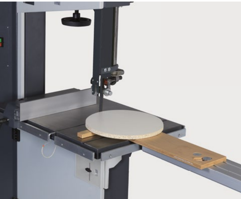
Dispositivo de corte circular Dispositivo de corte circular, para a realização perfeita de arcos circulares, segmentos de círculos ou círculos completos.
