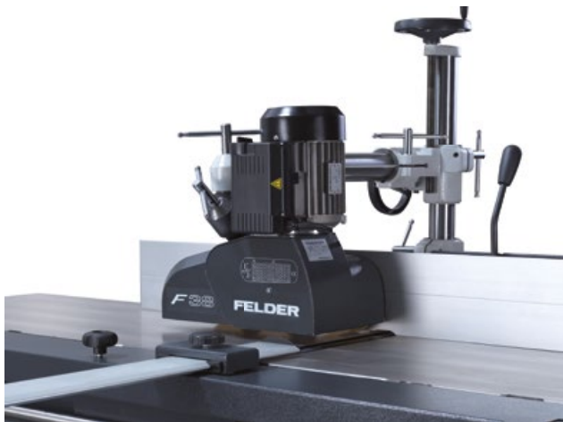
Alimentador O alimentador aumenta a segurança e melhora o conforto durante os trabalhos de alinhamento, sem reduzir a largura de aplainamento. Graças à pressão constante e uniforme, consegue-se um acabamento de aplainamento absolutamente uniforme.
