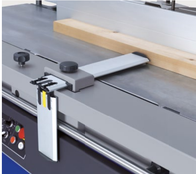
Protetor da plaina confortável Maior segurança no trabalho e conforto sem precedentes: a proteção da plaina integrada no suporte da máquina estabiliza a peça durante o aplainamento e trabalhos de encaixe.
