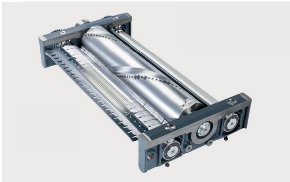
Estabilidade para o máximo desempenho O eixo da plaina é maciço e feito em bloco de ferro fundido, projetado para cargas muito pesadas. O rolo de alimentação dentado em aço e o rolo de saída microdentado em aço garantem um transporte perfeito da peça. Ambos os rolos de aço são grandes e resistentes ao desgaste.
