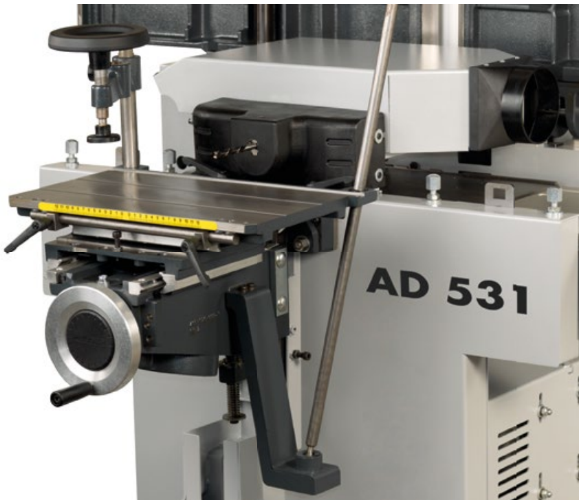
O dispositivo de perfuração A furadeira montase do lado da desempenadeira. Segundo as opções, podese equipar o suporte da furadeira com um dispositivo de deslocamento.
