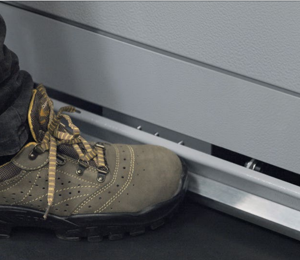
Komfortowa listwa nożna Od frontu, wzdłuż całej długości pola roboczego, w korpusie maszyny zintegrowana jest listwa nożna służąca do włączania. Problem związany z szukaniem lub przesuwaniem się pedału nożnego zostaje w ten sposób wyeliminowany. Prosta konstrukcja spójnie uzupełnia desing maszyny.
