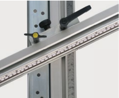
Gradenroosterindex Met behulp van de index-pasbouten kunt u de hoek in stappen van 5° en bij 22,5° fixeren.
