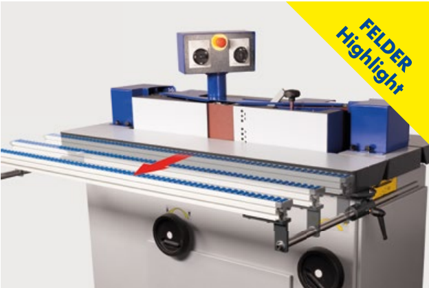
Tafelverbreding De tafelverbreding (14.0.950) kan worden uitgetrokken en wordt aan de onderkant van de machine gemonteerd. Ook geschikt voor montage achteraf op bestaande machines (optie).
