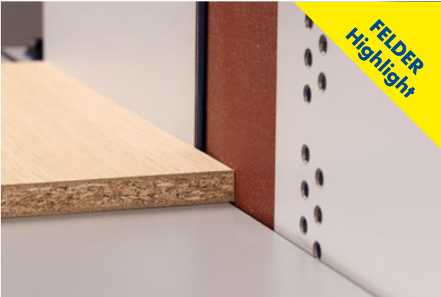
Fineerschuur-inrichting Standaard bij de FS 900 KF: de fineerkantenschuurinrichting.
