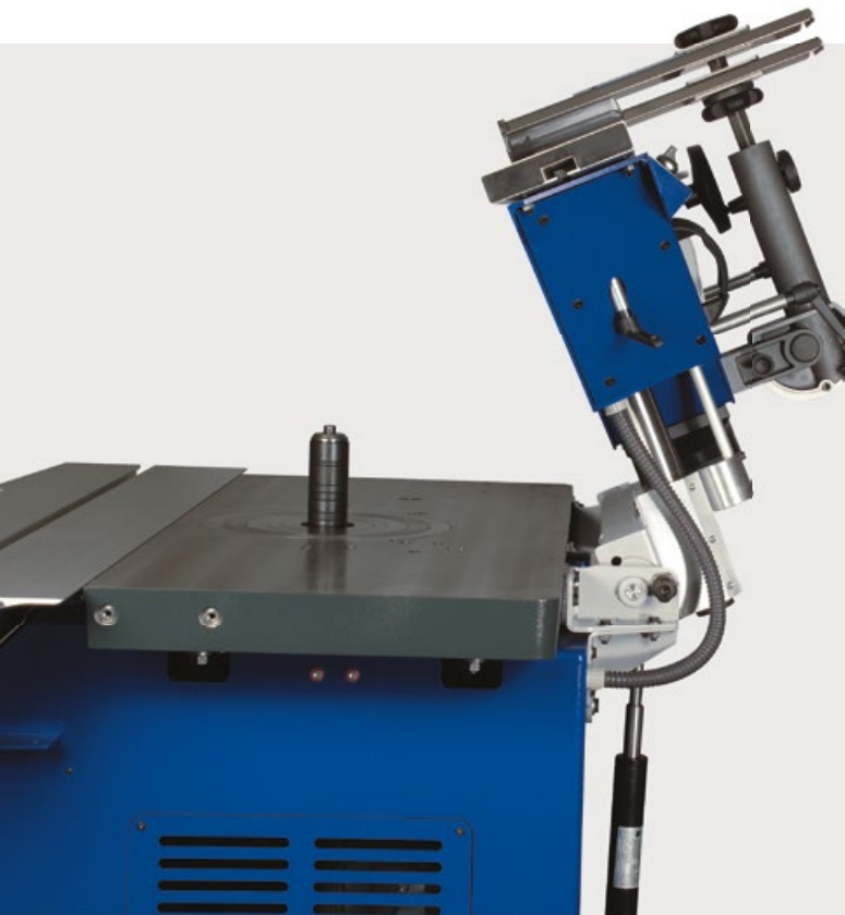
Fræseanslag-opklap anordning Vigtigt for et produktivt og hurtigt skift af fræseværktøjer og fræserspindler samt ved buefræsning.
