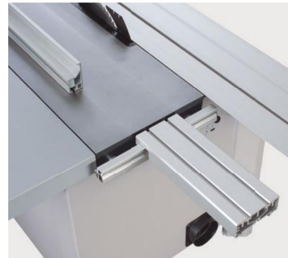
**In caso di necessità: adattamento delle dimensioni del piano alle dimensioni del pezzo**
