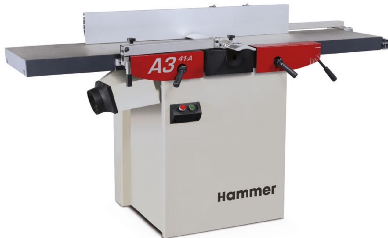
Dettagli quali il lunghi e massicci piani a filo in ghisa grigia con nervature di rinforzo forniscono la precisione necessaria per la piallatura a filo.
