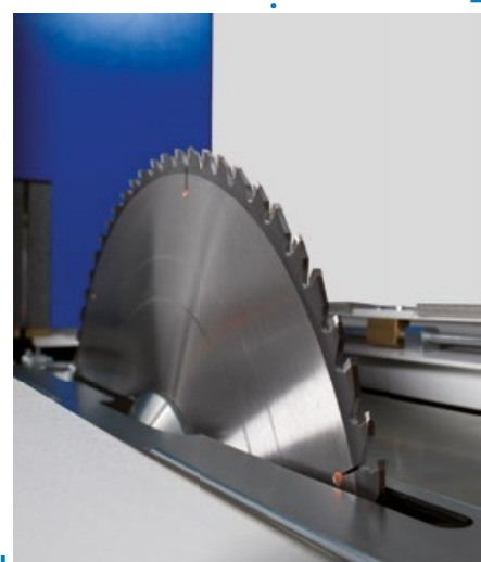
Zárt a fűrészkoszinak a burkolata, ami kiváló hatékonyságú elszívást eredményez.
