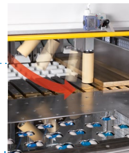
Csíkok, sávok vágására szolgál a pneumatikusan vezérelt rászorító, rögzítő egység.
