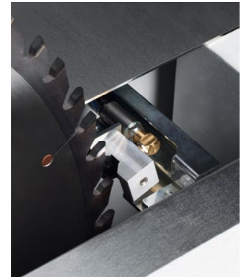
Fűrészkocsiba beépített minimális kenőanyagot bejuttató kenőrendszer (MMS) a fő fűrészlaphoz.
