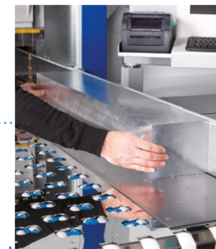
Légpárnával ellátott szög(dereksszög)asztal, sarokasztal könnyíti meg az anyagok a kezelését. Az univerzális, minden irányban elforduló görgők, a körkörös görgők energiatakarékossá módosítják a munkadaraboknak a kezelését.
