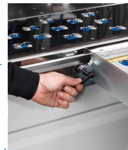
Mobil oldalsó asztal. Ezek az asztalok oldalról csatlakoztathatóak és a gyártó ellátta őket záró, rögzítő szerkezettel.
