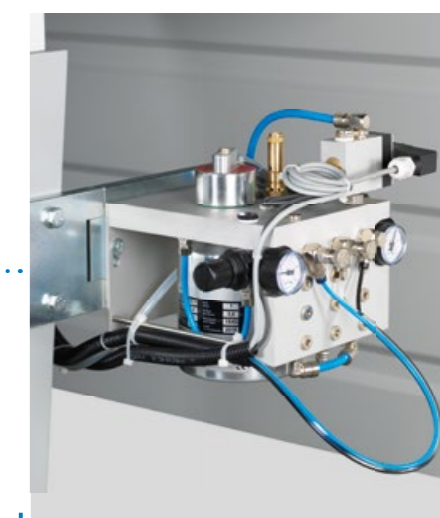
Minimális kenőanyagot igénylő kenési rendszer, ergonomikusan elrendezett kezelőegységgel.
