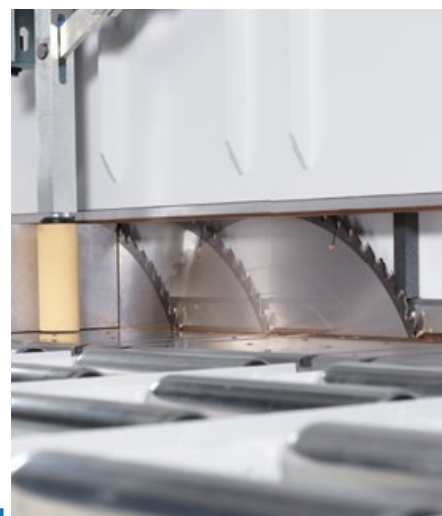
A nyomógerenda osztott, ami tökéletes elszívást eredményez az anyagok vágása során.
