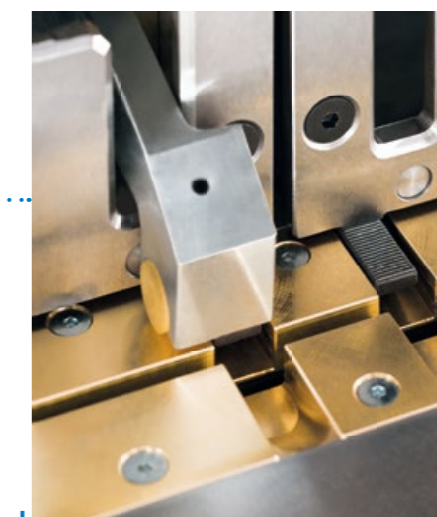
Színesfémből készülnek a vágóajkak. Ezeket szükség esetén ki lehet cserélni.
