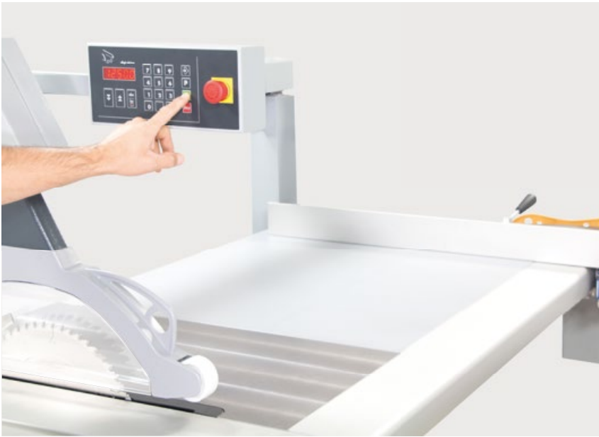
Guide de coupe parallèle sur commande Le nouveau guide de coupe parallèle commandé via un servomoteur garantit précision et simplicité de fonctionnement. La lecture de la côte s'effectue directement sur l'interface placée sous le chariot à format. La butée parallèle peut pivoter sur toute la longueur et permet une découpe parfaite avec une largeur maximale de 1250 mm.
