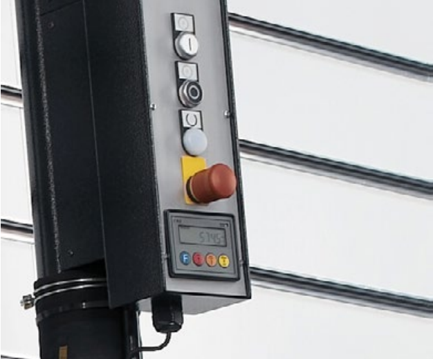
Butée numérique pour coupes horizontales La plus grande précision de découpe est garantie par les butées numériques pour l'usinage horizontal.
