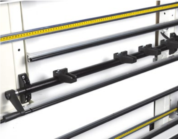
Support central Le support central inclinable couvre toute la longueur de la machine et peut être divisé pour des pièces plus petites.
