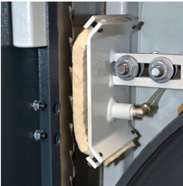
Application de lubrifiant L’application de produits lubrifiants assure des excellentes coupes dans l’usinage des métaux non-ferreux. Le réservoir du lubrifiant peut être fixé sur la machine de façon flexible à l’aide d’un aimant. Seulement pour FB 710 c-tech.
