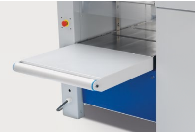
Rallonge de table Lorsque plusieurs pièces à usiner sont rabotées de manière simultanée, la rallonge de table de 570 mm de long équipée d'un rouleau pour pièces à usiner aide à la sortie lors du prélèvement des pièces usinées.
