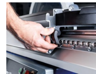
Fijar en cualquier posición. Múltiple fijación en el carro deslizante
