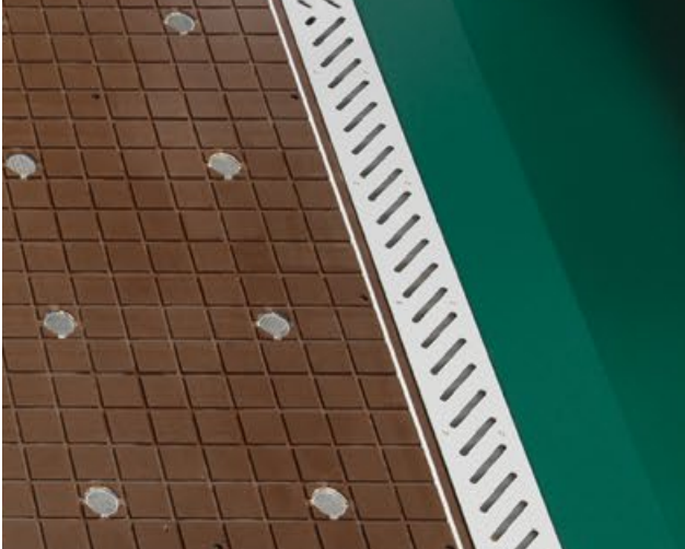
Aspiración por debajo de la mesa Las últimas virutas son completamente absorbidas por la aspiración debajo de la mesa entre la cinta transportadora y la mesa de trabajo.
