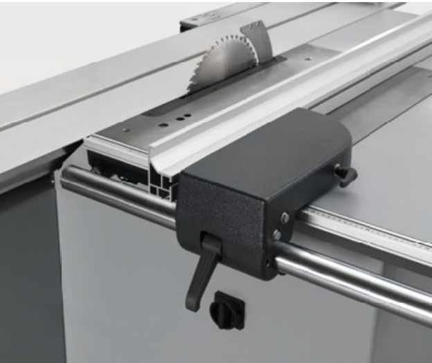
Der Parallelanschlag Die Parallelschnittbreite beträgt Standard 800 mm, auf Wunsch 1250 mm. Leichtgängig und präzise verstellen Sie den Parallelanschlag per Einhand-Schnellklemmung; beim präzisen Justieren hilft die integrierte Feineinstellung (optional). Die Parallelschnittsskala ist groß dimensioniert und perfekt im Kreissägetisch integriert. Das Alu-Kreissägelineal lässt sich für Absetzarbeiten oder zum besseren Zuführen von Werkstücken nach hinten verschieben. Für die Bearbeitung von besonders schmalen Werkstücken bei geschwenktem Kreissägeblatt kann das Alu-Kreissägelineal in die liegende Position gebracht werden.
