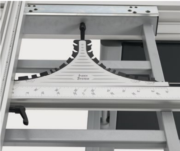
Auslegertisch mit Gradraster-Indexsystem Kein Zeitverlust durch mühevoll Herantasten an den Winkelwert und hundertprozentig genaues Justieren und Fixieren, ohne Ablesefehler, sind die Vorteile des Gradraster-Indexsystems. Hochpräzise Rastpunkte erlauben so die maßgenaue Anfertigung von Vielecken wie z. B. 5,625° (32eck), 11,25° (16eck), 22,5° (8eck). Zusätzliche Rastpunkte bei 15°, 20°, 25°, 30°, 35°, 40° und 45° können sowohl auf Schub als auch auf Stoß gewählt werden. Jeder Rastpunkt ist mit einer Längenkompensation ausgestattet. Das hochpräzise Gradraster-Index-System ist werkseitig eingestellt und jeder Rastpunkt kann einzeln feinjustiert werden. Das formschön dem Maschinendesign angepasste Gradraster-Index-System steigert Ihre Produktivität zu einem einzigartigen Preis-Leistungs-Verhältnis.
