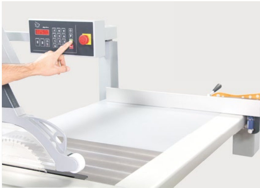
Gesteuerter Parallelanschlag Auf einem wartungsfreien Linearführungssystem mit Kugelumlaufspindellagerung verfährt der elektromotorische Parallelanschlag schnell und zehntelmillimetergenau gemäß der eingegebenen Schnittbreite. Der Parallelanschlag ist auf der gesamten Länge abschwenkbar und ermöglicht perfekte Schnitte mit einer maximalen Breite von 1250 mm.
