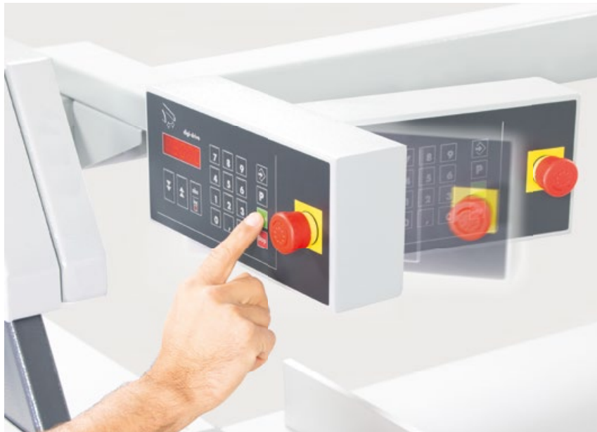
Das Felder Bedienterminal - intuitiv und übersichtlich Auf einem wartungsfreien Linearführungssystem mit Kugelumlaufspindellagerung verfährt der elektromotorische Parallelanschlag schnell und zehntelmillimetergenau gemäß der eingegebenen Schnittbreite. Der Parallelanschlag ist auf der gesamten Länge abschwenkbar und ermöglicht perfekte Schnitte mit einer maximalen Breite von 1250 mm. Das Bedienterminal versorgt Sie in Echtzeit mit allen Informationen zum Parallelanschlag. Schnell und einfach geben Sie die erforderlichen Maße am übersichtlichen Bedienfeld ein, sparen Zeit und steigern dadurch Ihre Produktivität.
