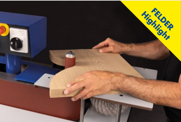
Ekstrabord og spændedorn Ekstrabord (14.0.951) og spændedorn (14.0.952) til buede og runde emner monteret med få greb og giver mulighed for slibning af mindre radier med spændedornen (tilvalg).
