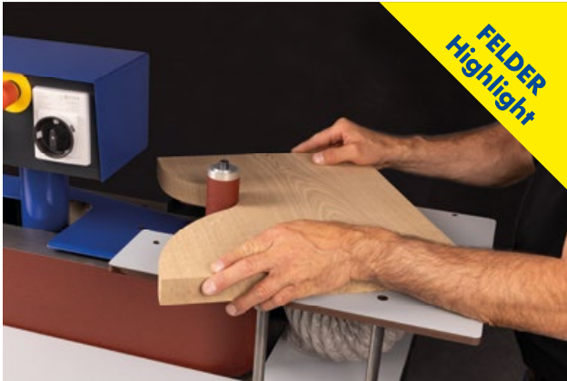
Přídavný stůl a upínací trn Montáž přídavného stolku (14.0.951) a upínacího trnu (14.0.952) pro broušení zakřivených profilů a zaoblení je velmi snadná a umožňuje broušení malých poloměrů (volitelná výbava).
