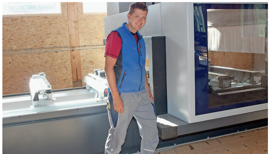
Das Bumper-Sicherheitssystem mit eingebauten Sensoren stoppt die Maschine im Notfall.
