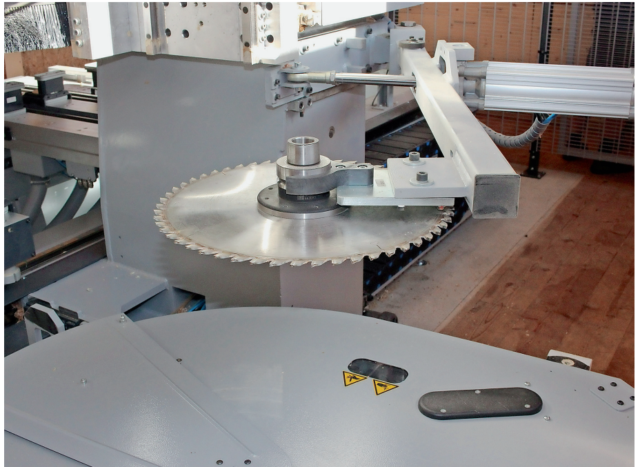
Detail am Rande: Der leuchtende Schriftzug zeigt je nach Farbe den Maschinenstatus an. Das 350-mm-Sägeblatt fährt mit.
