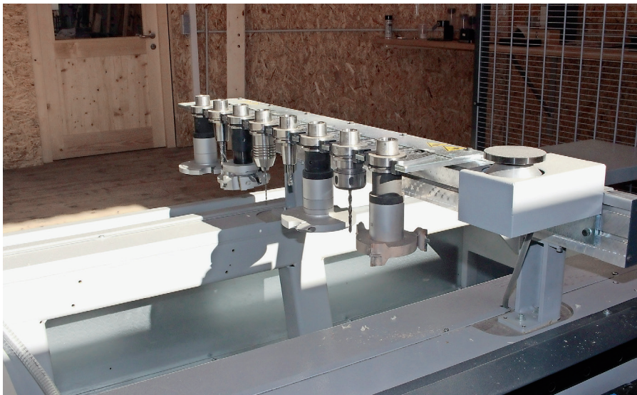
Das Pick-up-Werkzeugwechselsystem und der Tellerwechsler (rechtes Bild) mit mitfahrenden Werkzeugen.
