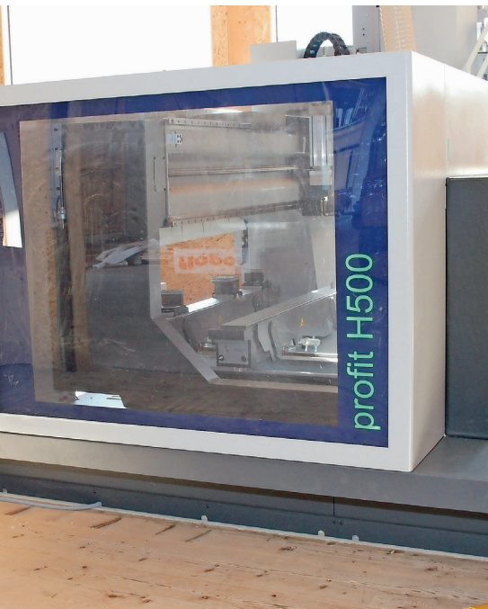
Detail am Rande: Der leuchtende Schriftzug zeigt je nach Farbe den Maschinenstatus an. Das 350-mm-Sägeblatt fährt mit.
