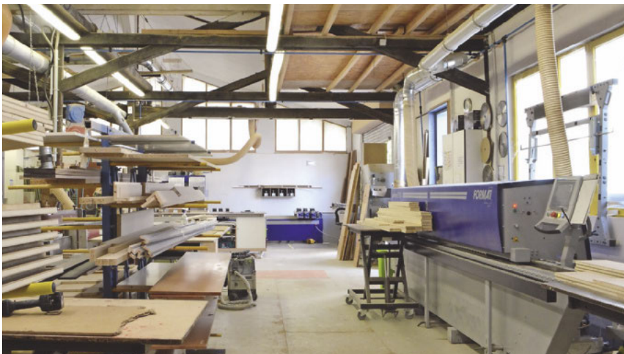
Die Platzverhältnisse sind beengt, die Werkstatt liegt in einem Vorort von Heidelberg. Neben der Schleifmaschine sind auch CNC und Kantenanleimmaschine von Format4
