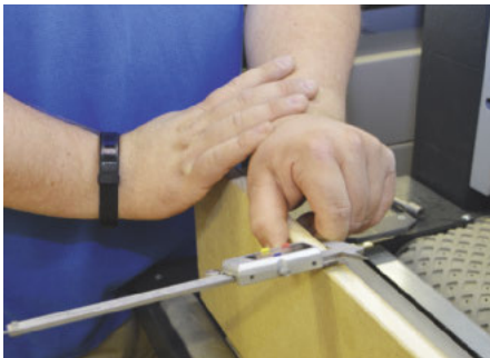
Obligatorisch: die exakte Messung der Plattenstärke vor der Bearbeitung
