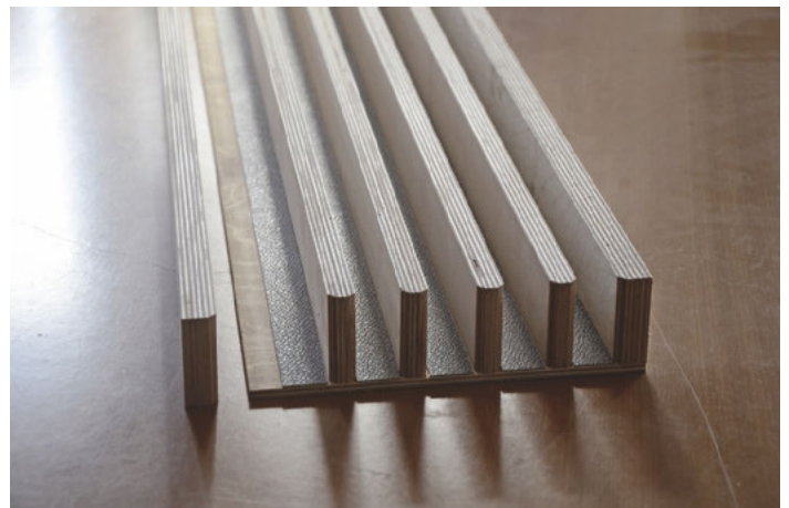
/ Die Streifen müssen auf die Rillenplatten der Einschübe geleimt werden, vorher wurde die Beschichtung der Multiplexplatten auf's Zehntel genau abgefräst.
