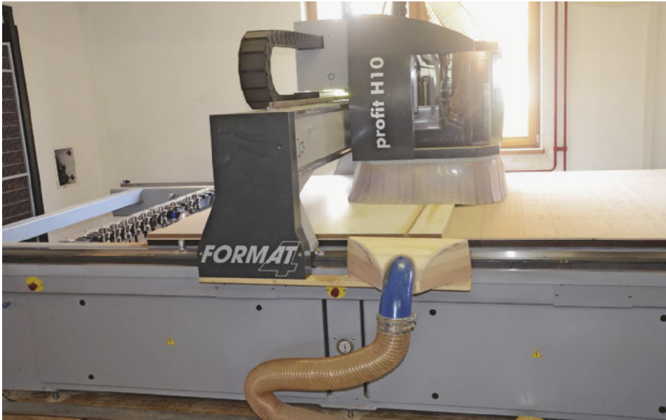
Die 4-Achs-CNC-Nestingmaschine Format-4-Profitec-H10 verfügt über ein Magazin mit 16 Werkzeugplätzen. Im Moment sind neun Plätze für Bohrer und Fräser besetzt, zusätzlich werden für die Sägeeinheit zwei Plätze benötigt.
