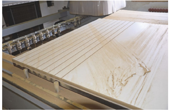
/ Massenfertigung in der Ein-Mann-Schreinerei: 3600 Streifen und 600 Rillenplatten werden benötigt, um 300 Industriekoffer für Beleuchtungsfiler auszustatten.
