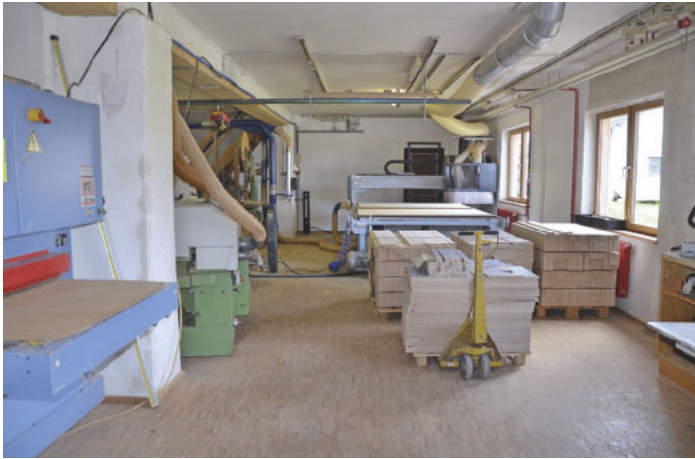
/ Optimaler Fertigungsfluss: Heute werden die Multiplexplatten im Standardformat mit dem Gabelstapler direkt an die Nestingmaschine herangefahren.
