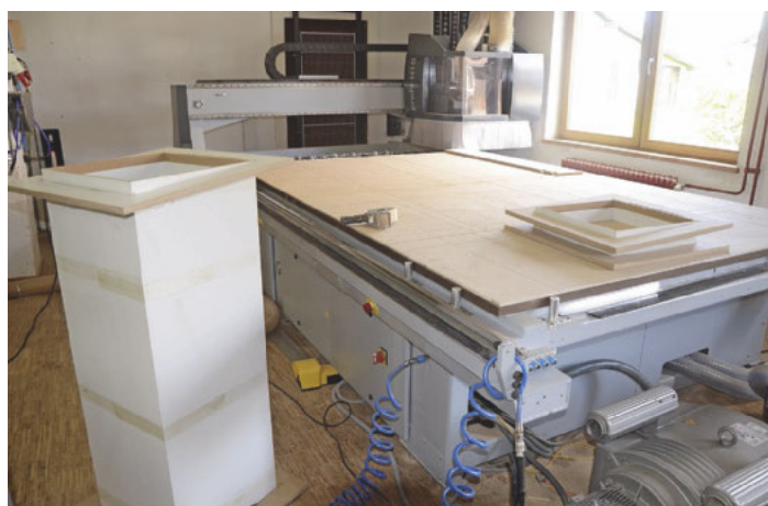
/ ... bis er mit Schablonen – die am Sockel und on top des Vitrinenkörpers positioniert werden – die nötige Festigkeit vermitteln und der Leim abgebunden hat.
