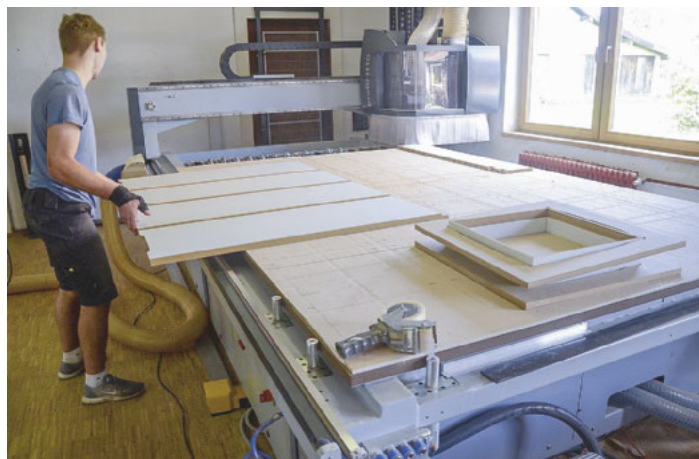
/ Noch auf dem Maschinentisch des Nesting-BAZ wird Leim in die gefrästen Gehungen gegeben und der Korpus für die Vitrinen zum Aushärten zusammengefalzt.
