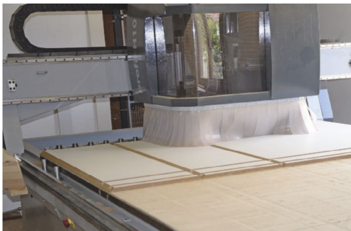
/ Ausfräsungen aller Art und Nietenbohrungen für versenkte Griffe und Beschläge sind unschlagbar schnell und präzise mit dem CNC-gesteuerten Nesting-BAZ herzustellen.
