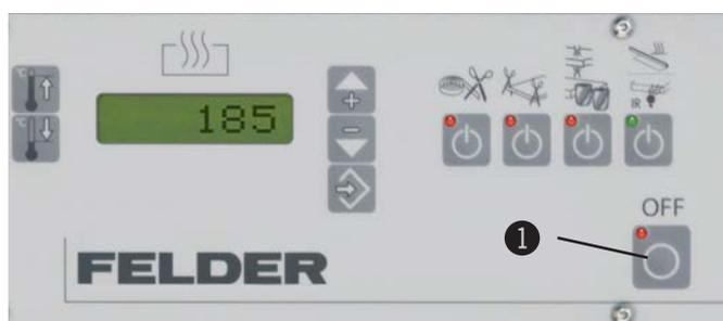
Fig. 10-2: Elementos eléctricos de control
