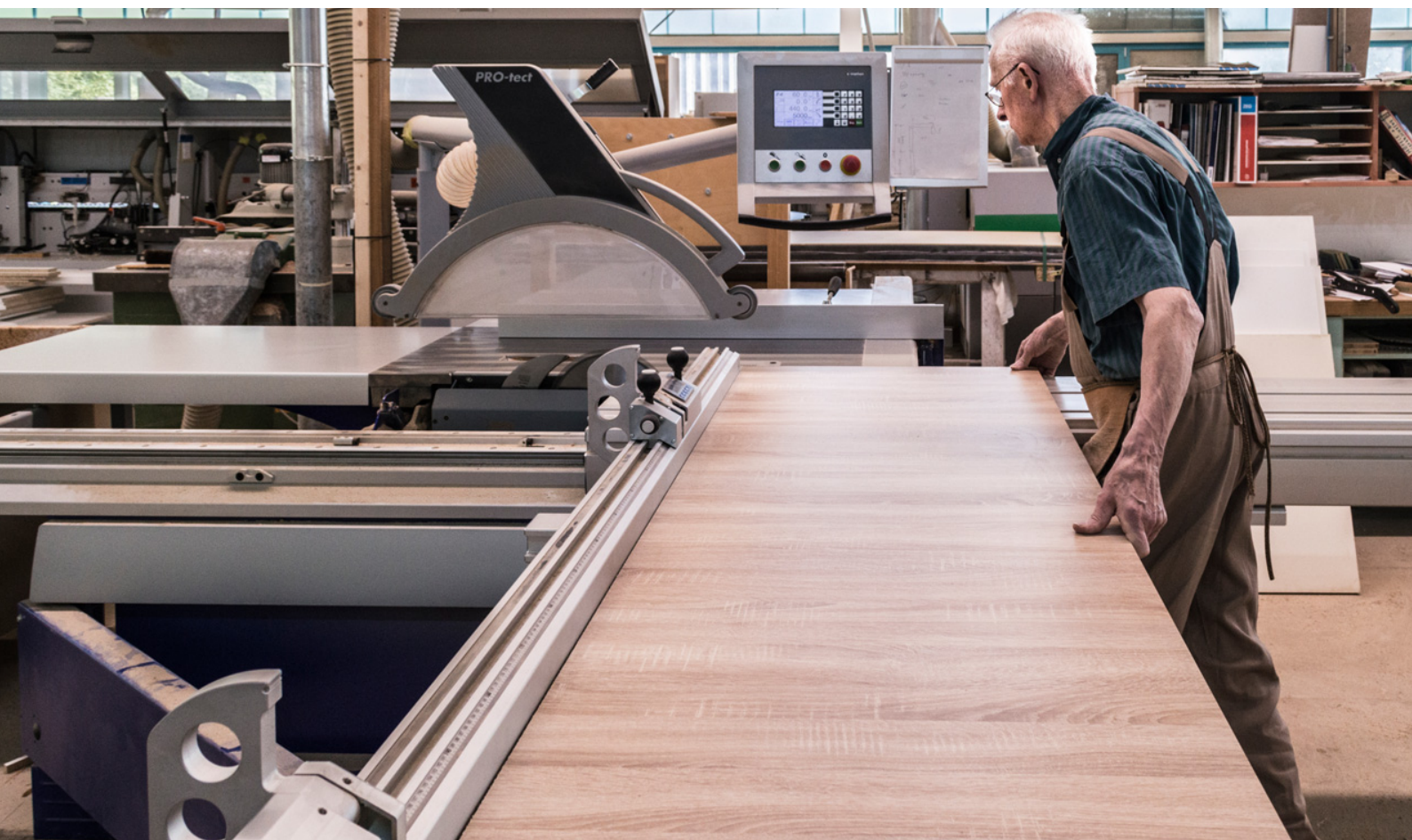
Robert Schmidgall hat das Kopfschnittende der Halbformatplatte aufgelegt und wird diese am Parallelanschlag in Streifen aufteilen
