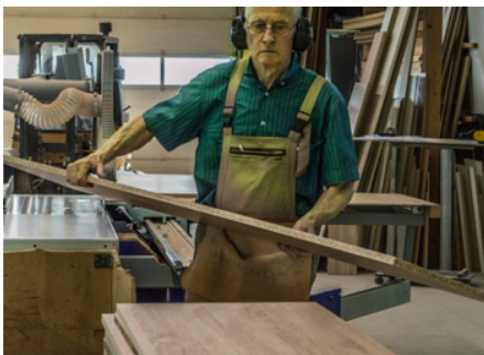
... schneidet sie mit Übermaß in Streifen ...
