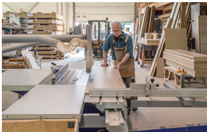
Inzwischen hat er den Wagen vor die Säge geholt und schneidet die Steifen mit einem Besäum- und einem Parallelschnitt auf Endformat
