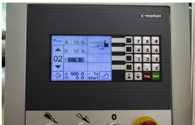
Es lohnt sich nicht die Tischfräse für eine Nut einzustellen. Mit dem Nutprogramm lässt sich das auf der Säge flink erledigen
