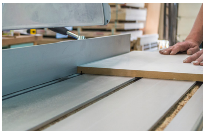
Jeden Durchgang quittiert Hansjörg Schmidgall mit Start sodass der Parallelanschlag um eine Sägeblattstärke weiterrückt
