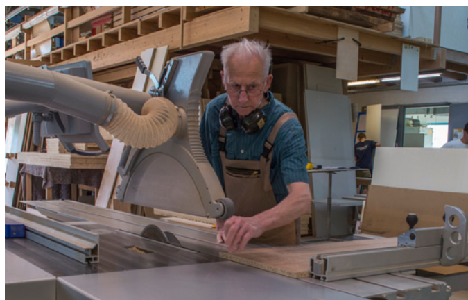
Die Anschlagklappe hat er nach Digitalanzeige eingestellt und längt den Streifen jetzt von beiden Seiten ab
