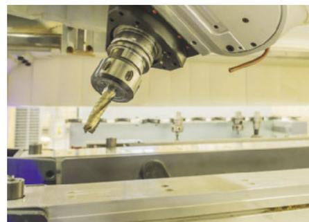
Die Fünfachsspindel der CNC verleiht Goertz die 3D-Fähigkeit und spart Aggregate
