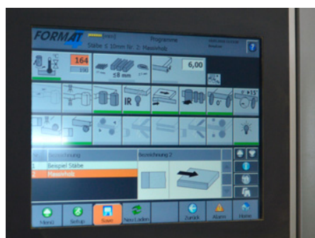
Mit Piktogrammen erklärt sich die Maschinensteuerung quasi von selbst
