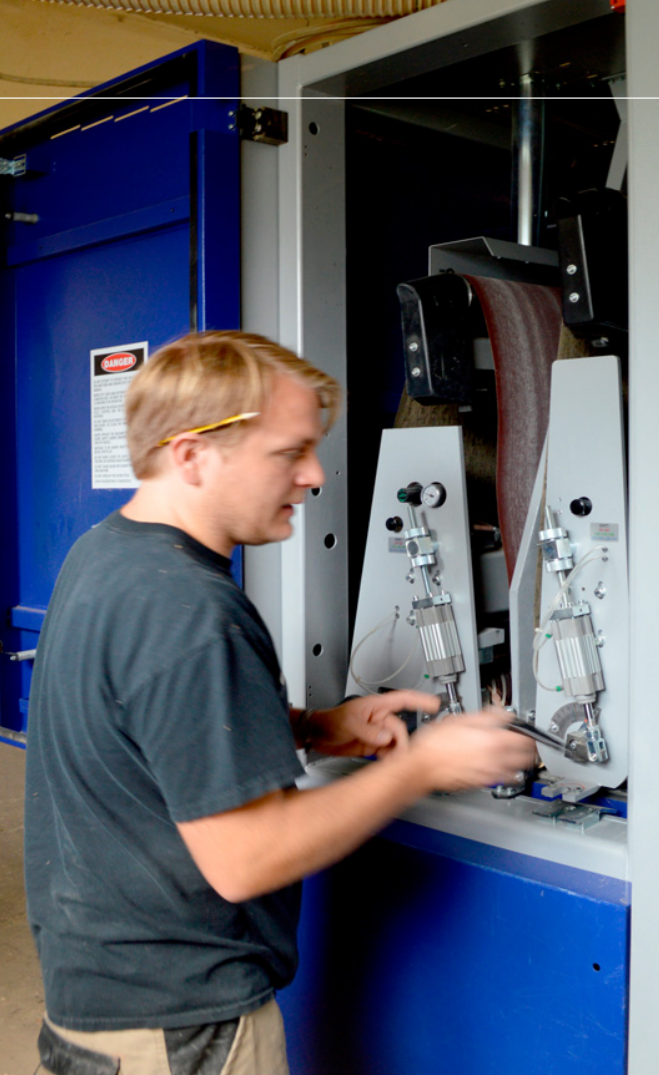
Für den Bandwechsel löst Xaver Mayerl die Arretierung
