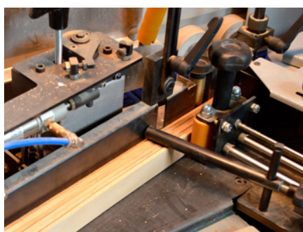
Das passt zu Mayerls Arbeitsweise: das Streifenmagazin für Massivholzkanten
