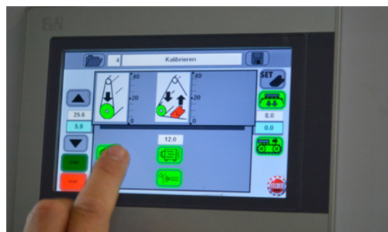
Er wählt zwei Walzen, eine kalibriert, eine schleift nach. Auf P 80 folgt P 100
