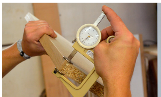
Xaver Mayerl misst die Dicke der Platte. Auf jeder Seite möchte er 1/10 mm wegschleifen
