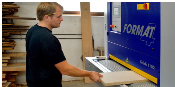
Damit das Schleifband gleichmäßig abnutzt, legt er die Werkstücke mal rechts, mal links und mal in der Mitte auf
