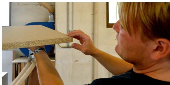
Ein Höhenunterschied zwischen Platte und Anleimer kann Xaver Mayerl weder ertasten noch mit dem Auge ausmachen
