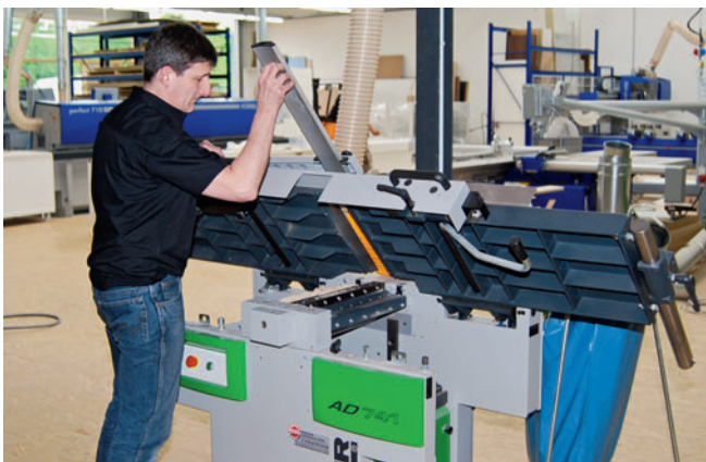
Flinker Moduswechsel: die Abrichtdickenhobelmaschine AD 741
