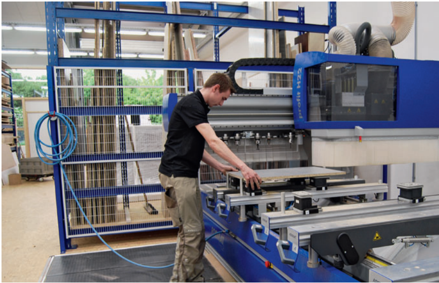
Viereinhalb Achsen, 3000 x 1300 Millimeter Arbeitstisch, Woodflash-Programmiersystem mit Korpusgenerator: Auch ohne BAZ-Erfahrungen läuft die Profit H22 problemlos und zuverlässig
