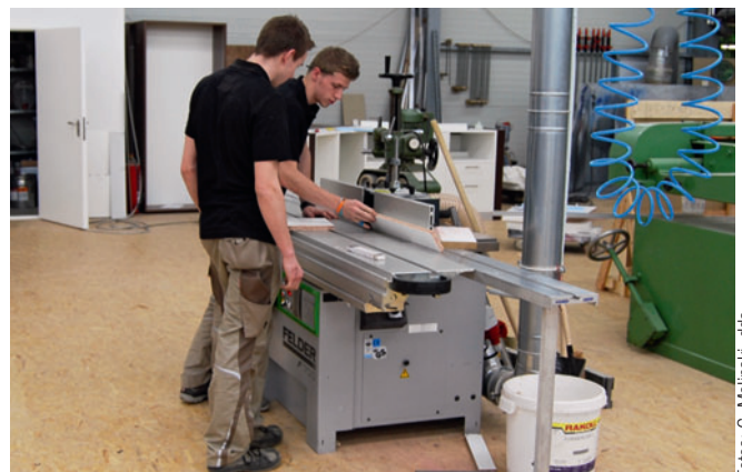
Mit praktischem Schiebeschlitten: die Tischfräse F 700
