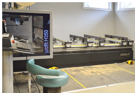
Der Typenschriftzug der neuen CNC leuchtet blau, das signalisiert dem Anwender einzugreifen
