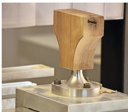
Ein Schlosser hat die Spannvorrichtung für den Straßenbahnschaltgriff gefertigt
