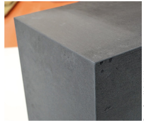
Der fertige Würfel: dank der CNC-Technik und des Tenso-P-Verbinders passt alles
