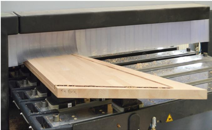
Erstmal halbe Materialstärke: das Formatieren der 45 mm dicken Stufen erfolgt in zwei Schritten
