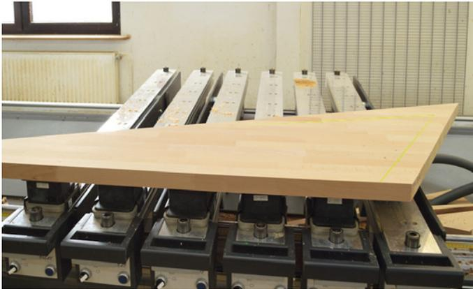
Die auf den Rohling projizierte Fräsbahn erleichtert das Positionieren der Sauger. Wegen der geringen Deckenhöhe, sitzt der Laser ...
