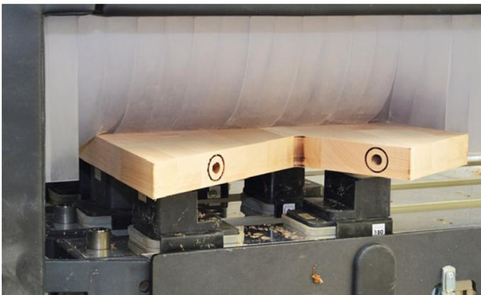
Typische Anwendung: die Stufenbohrungen für die wandseitige Befestigung bei handlaufgetragenen Treppen
