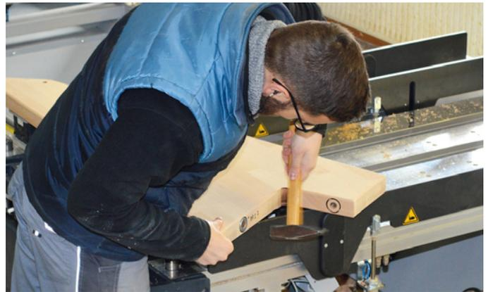
Die fertigen Treppenstufen gehen von der CNC noch zur Breitbandschleifmaschine und dann in die Oberfläche
