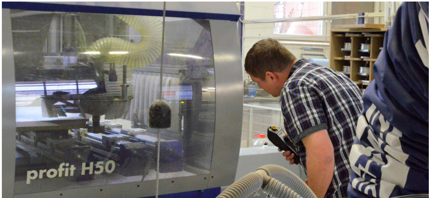
Markus Bäumer kontrolliert die Bearbeitung auf der Fünfachmaschine. Mit dem Handterminal steuert er die Verfahrensgeschwindigkeit
