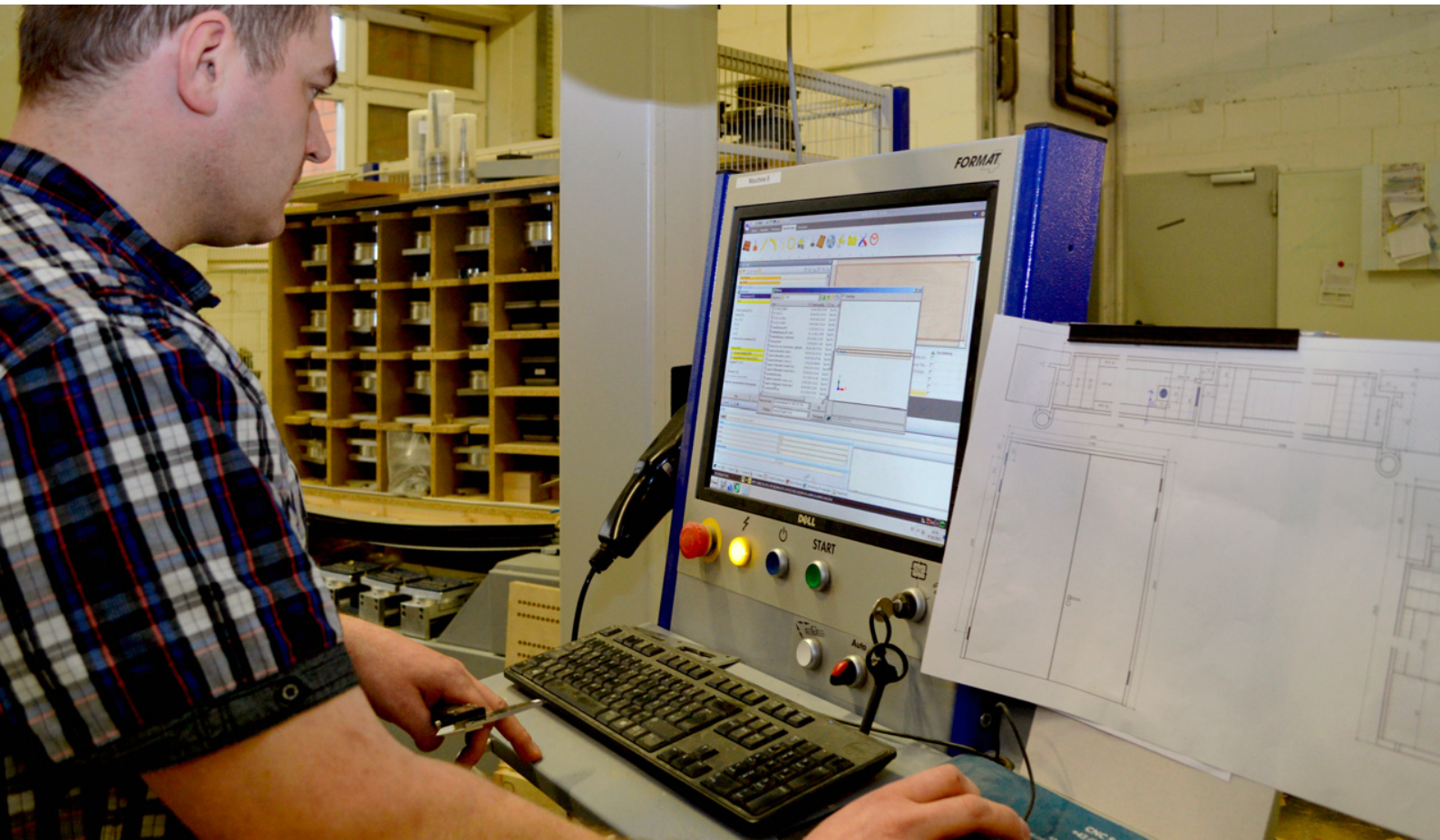
Markus Bäumer an der Fünfachs-CNC von Format-4: Per drag & drop positioniert er die Bandaufnahmen am Türblatt
