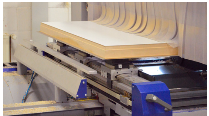
Um extrem saubere Kanten auch bei großen HPL- und Furnierüberständen zu erzielen, wird im Gleichlauf gefräst
