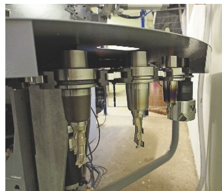
/ Hoffmann legt Wert darauf, dass alle Werkzeuge immer in der Maschine sind. Die bietet ihm 34 Plätze.
