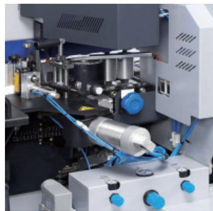
Das »advantEdge«-Aggregat ermöglicht eine optische Nullfuge bei co-extrudierten Kanten- und Laserkantenmaterialien.
