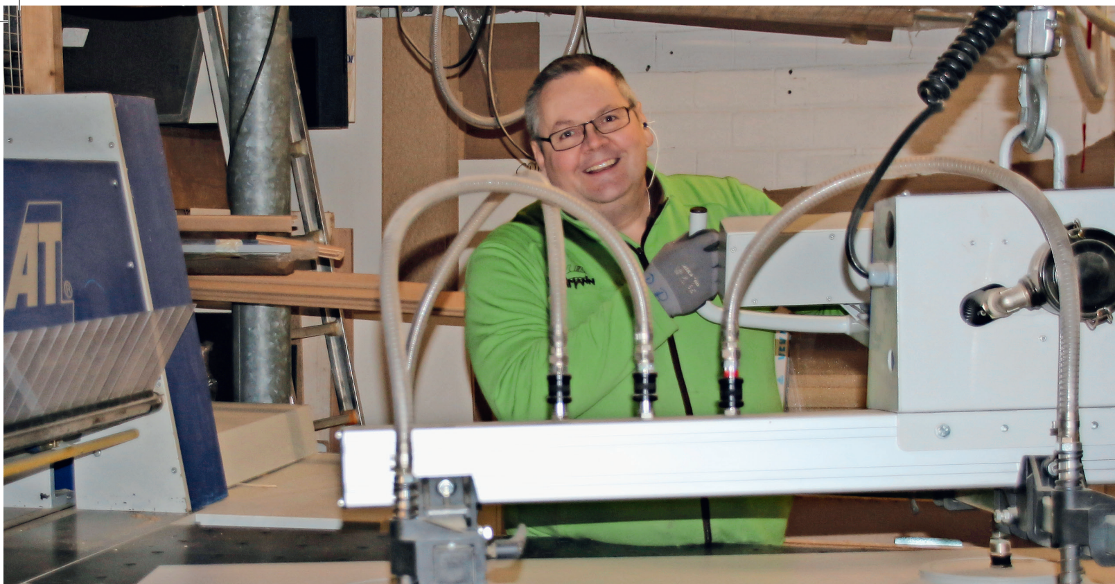
Die Plattensäge ist in den Arbeitsabläufen die erste Station. Der Vakuumheber erleichtert die Arbeit.
