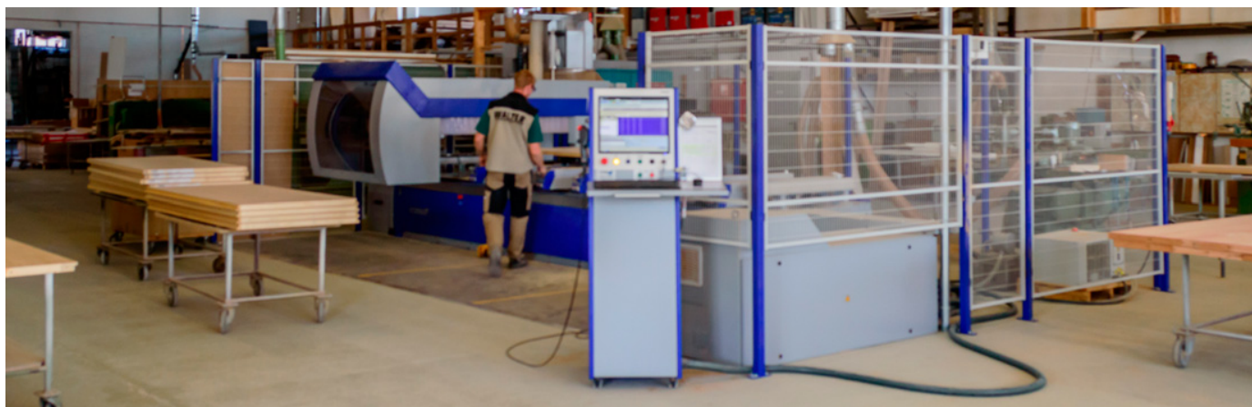
Die zentrale Maschine in der Schreinerei Walter: das Bearbeitungszentrum Profit H50
