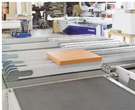
Lichtschranken lassen Querförderbänder automatisch auf- und abtauchen
