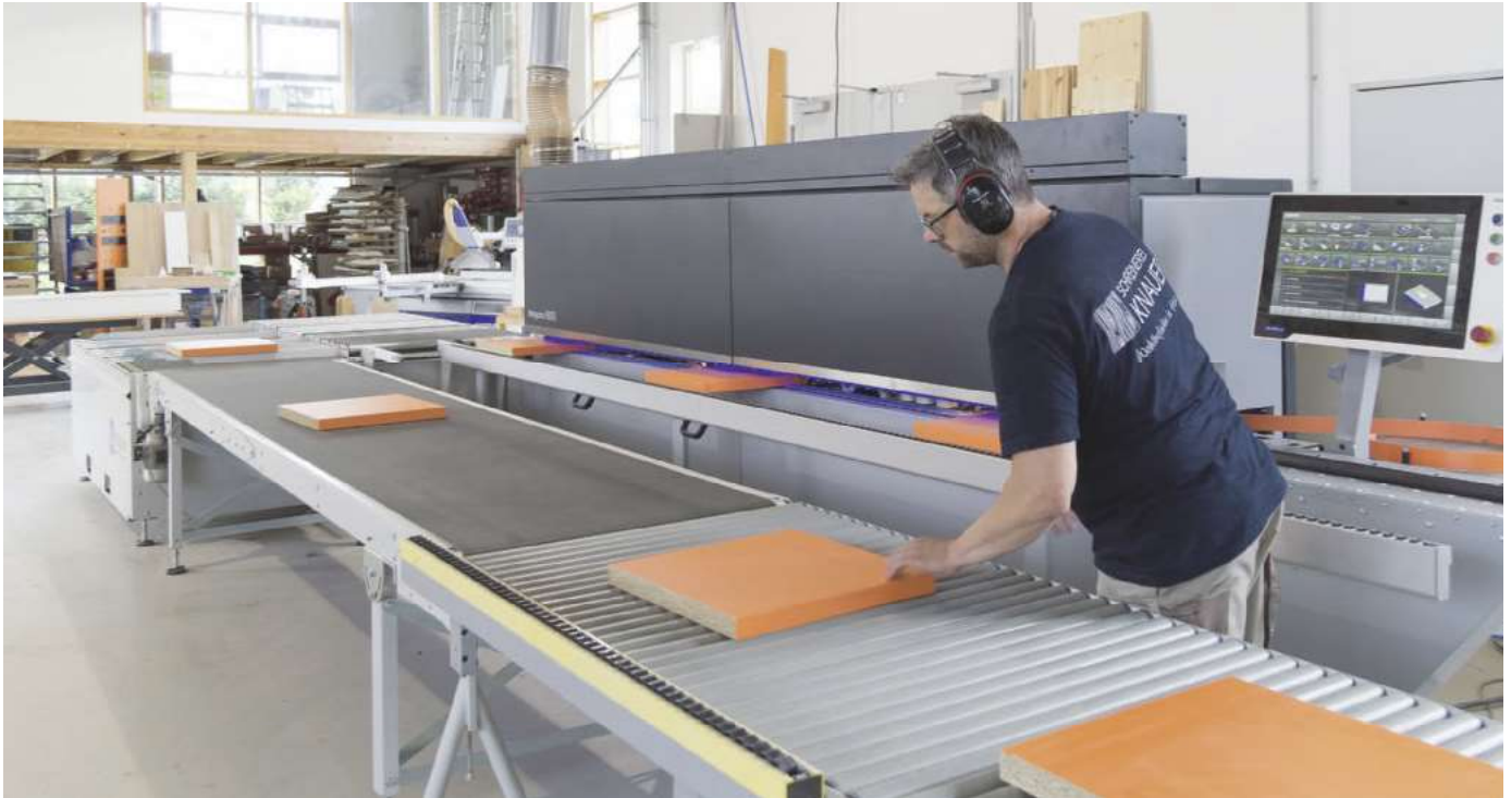
Daniel Knauer bedient seine neue Kantenanleimmaschine
