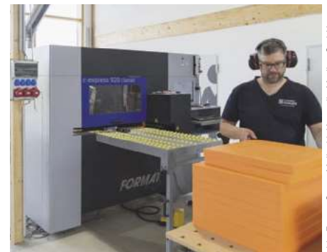
Daniel Knauer beschickt die Durchlauf-CNC. Er braucht keine Sauger zu positionieren
