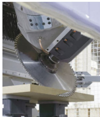
Schifterschnitte lassen sich mit CAD/CAM effizient ausführen
