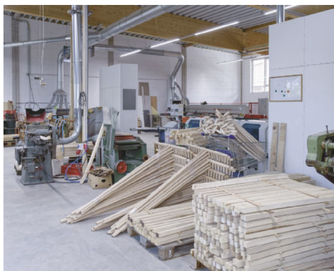
Eine alte aber robuste und starke Spezialmaschine (links) rundet die an der Bandsäge ausgeschweiften Schaufelstiele ab
