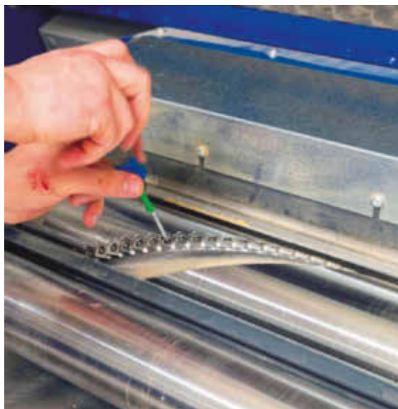
Dieser Schraubendreher stellt den sicheren Sitz der Messer sicher und verhindert Schaden an der Welle
