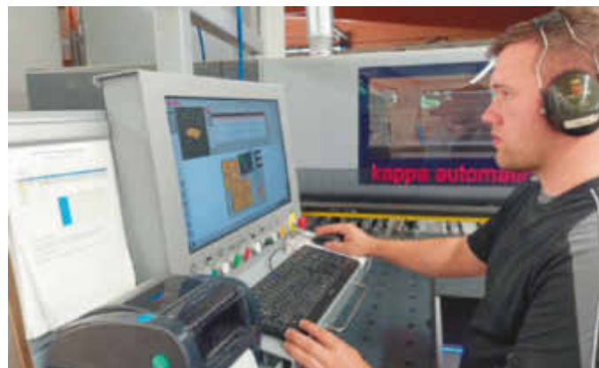
Auch der Zuschnitt lässt sich mit der Plattensäge von Format4 und dem Barbaric-Plattenlager von nur einer Person bewältigen
