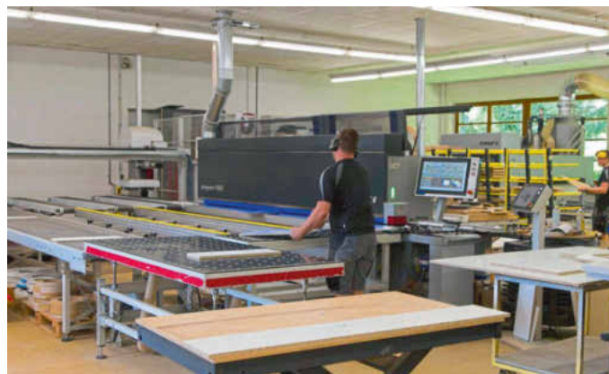
Einmannbedienung an der Format4-Kantenanleimmaschine mit Rückführung von Barbaric
