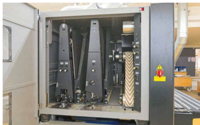
Der Durchlauf erfolgt von rechts nach links: Station 1 Querschleifen, 2 Längskalibrieren oder Vorschleifen und 3 Kontaktschleifen
