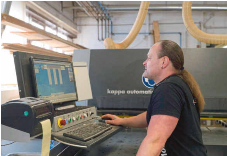
Michael Dost ruft an der Säge den im Büro erzeugten Schnittplan auf
