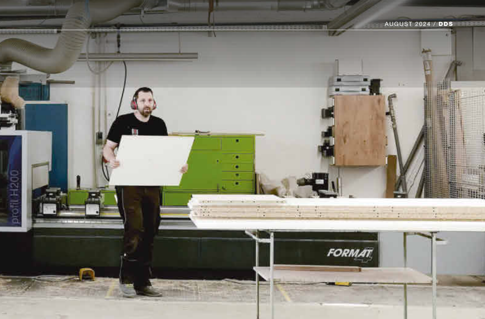
Zwei CNCs arbeiten eine riesige Liste von Programmen ab. Rechts beschickt Stefan Kranz die H200 mit kurzen Werkstücken im Pendelbetrieb, links unterstützt ihn Jürgen Steffens an der Creator 950
