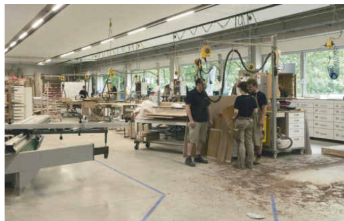
Die Handarbeitsplätze befinden sich an den Fenstern, häufig gebrauchte kleine Maschinen direkt dahinter
