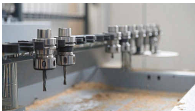
Die H350 hat zwei Werkzeugwechsler, links vom Tisch diesen und hinten am Portal einen mitfahrenden tellerförmigen
