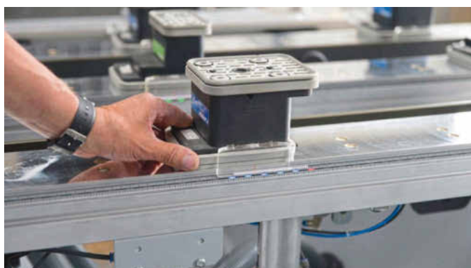
LED-Lichtleisten an den Traversen und am Maschinentisch weisen den Weg zur richtigen Position der Elemente
