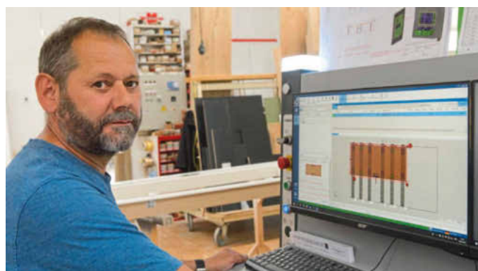
Rudi Geitner hat die Tür über Parameter beschrieben. F4Intergarte generiert daraus ein CNC-Programm
