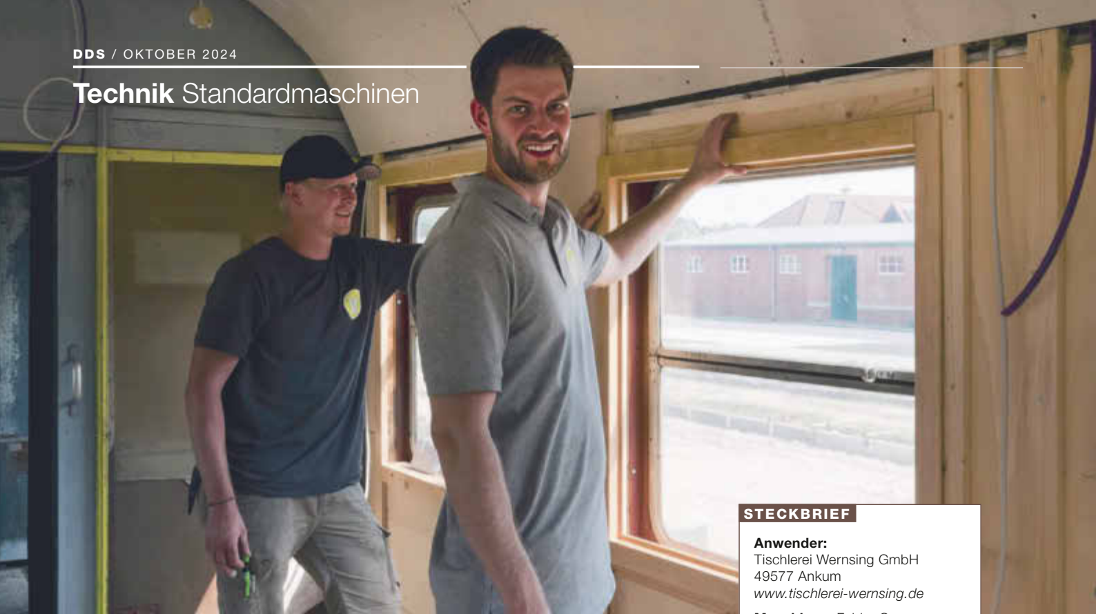
Pascale Wernsing (rechts) zeigt, wie die Zusatzfenster vor den originalen sitzen. Dahinter hält Tobias Determann ein Vertäfelungselement an seinen Platz
