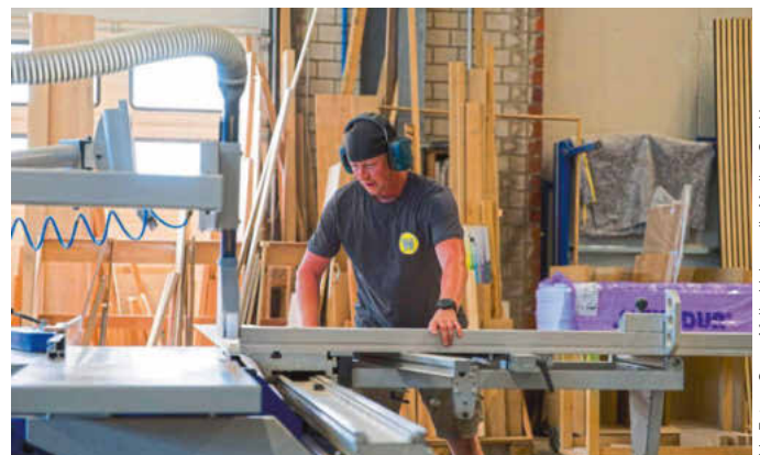
... während Tobias Determann auf Endformat sägt. Den Vorritzer braucht er dank Fügestation in der Kantenanleimmaschine nicht
