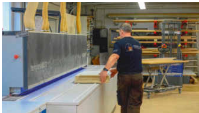
Kreative Ein-Mann-Lösung: Der Kantenbandschrank dient als Stütze und Rückföhrbahn, die Membranpresse als Puffer am Auslauf
