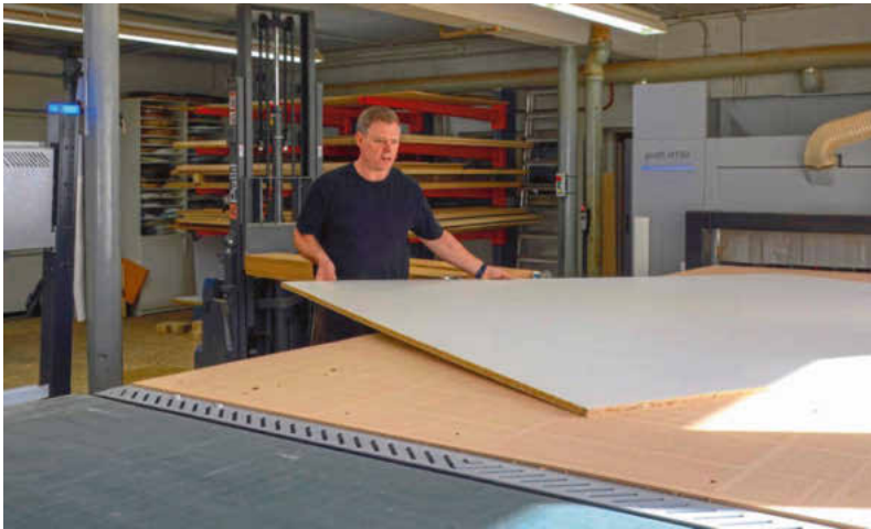
Mit einem Hubwagen bewegt Andreas Bertl die Platten ganz alleine. Verkleidete Gabeln und stirnseitige Rollen schonen die Platten beim Ziehen und Schieben
