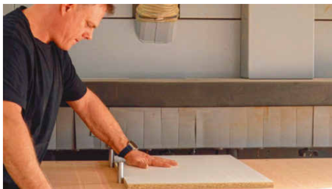
Zwischenwände sind auch von der Rückseite zu bearbeiten. Mit dem QR-Code-Etikett und den Anschlägen geht das ganz flink
